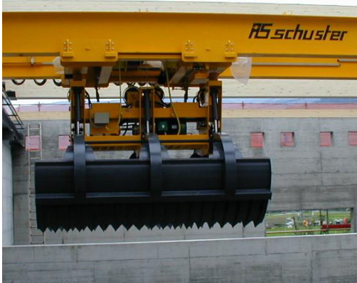
2-Schalengreifer für Holzackschnitzel Greifervolumen 2,5 m 3 - 4,0 m 3 Antriebsleistung: 11 kW
