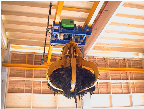
Polypgreifer offen für Rinde Greifervolumen ca. 3 m 3 Antriebsleistung: 11 kW
