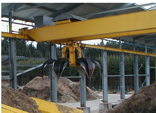
Polypgreifer geschlossen für Holzackschnitzel Volumen ca. 8 m 3 Antriebsleistung: 22 kW
