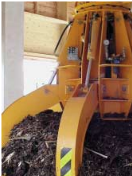
3: Die Erfassung der Signale am Greifer geschieht direkt vor Ort über AS-Interface-Kompaktmodule K 60
